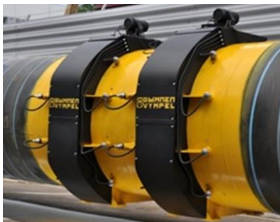
Рисунок 3 – Комплекс измерительный ультразвуковой «Вымпел-500» исполнение «02»
